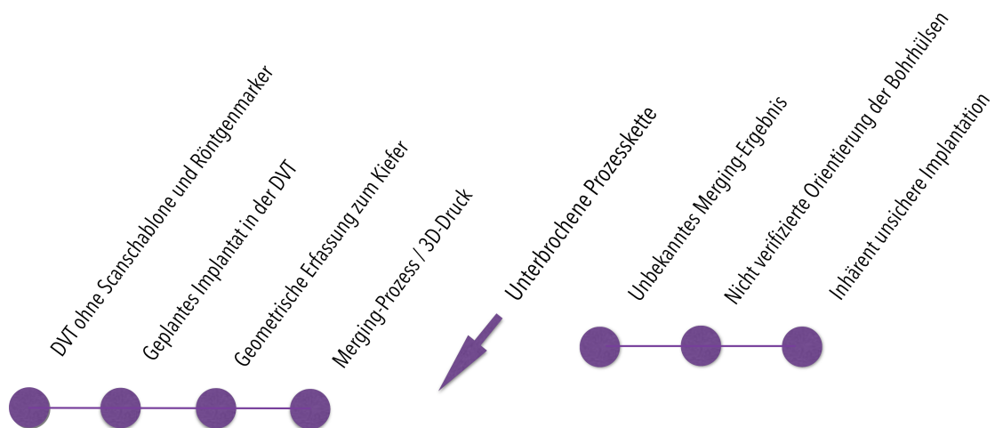
Abb. 31: Lückenhafte Verfahrenskette der Rapid-Prototyping-Bohrschablonen, deren Geometriedaten aus dem Matchen von DICOM und STL-Daten hergeleitet sind. Bei diesen Schablonen gibt es infolgedessen keine Bezugspunkte, die eine Rückverfolgbarkeit zur Genauigkeitskontrolle ermöglichen.
